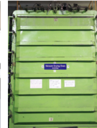
● 変圧器鉄心乾燥炉
